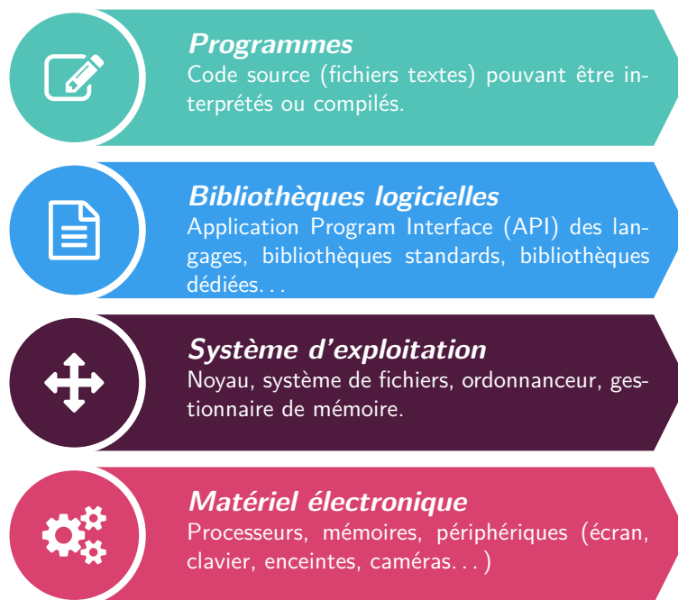
FIGURE 4 – Positionnement du système d'exploitation et des bibliothèques logicielles entre les éléments logiciels et le matériel électronique
